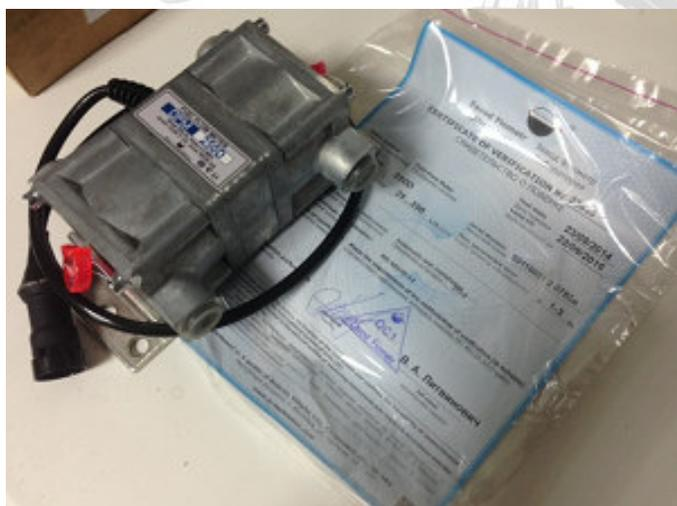
В тех случаях, где нет возможности врезать топливный датчик, устанавливаем проточные системы учета топлива.
